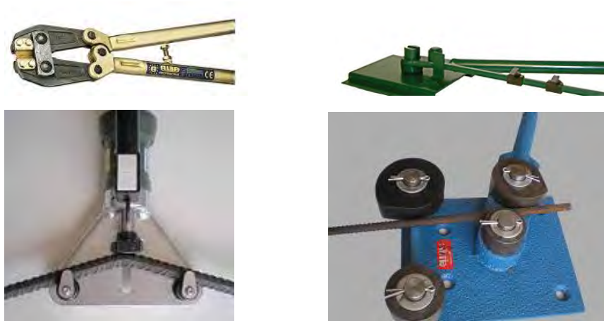
Fig. 4.11. Vegla për prerje dhe lakim të armaturës
