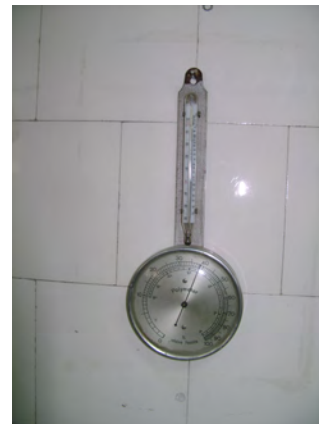
Figura 1.15. Instrumentet për matje të temperaturës dhe lagështisë në hapësirë
