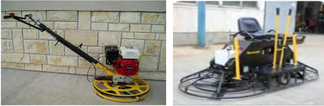
Fig. 2.36. b) Makina për rrafshimin e betonit
