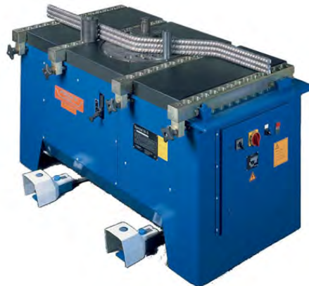
Fig. 4.12. Makina për prerje dhe lakim të armaturës
