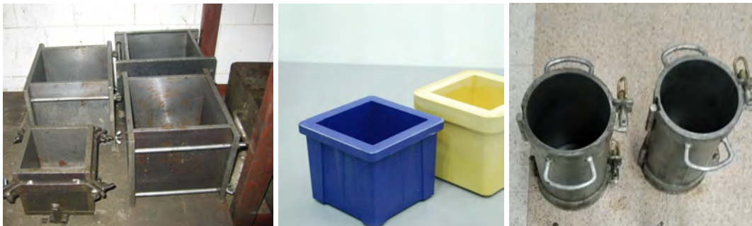
Fig. 3.2. Kallëp prej metalit për përfitim të kubeve provuese 15/15/15 dhe 20/20/20 cm dhe kallëpe për trupa provë cilindrikë me d=15\text{ cm} dhe h=2d .
