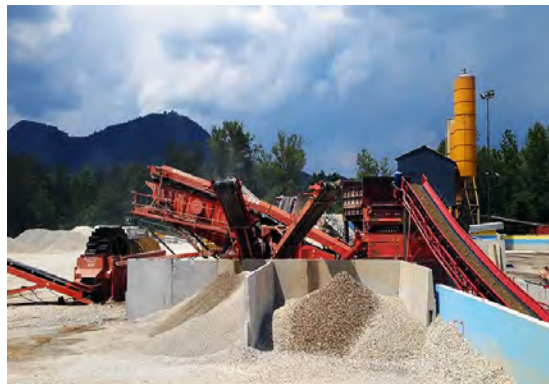
Fig. 1.24. Separacionet për agregat në kuadër të fabrikës për beton
