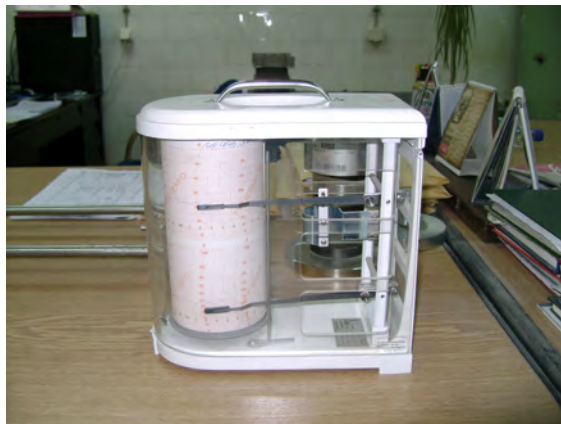
Figura 1.15. Instrumentet për matje të temperaturës dhe lagështisë në hapësirë
