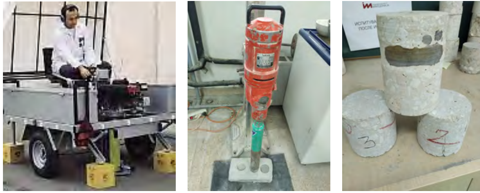
Fig. 3.9. Makina për nxjerrjen e mostrave nga konstruksionet e gatshme dhe trupat testuese të nxjerra
