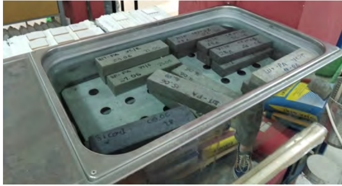
Figura 1.15.a. Enë me ujë në të cilën mbahen prizmat deri në momentin e shfrytëzimit
