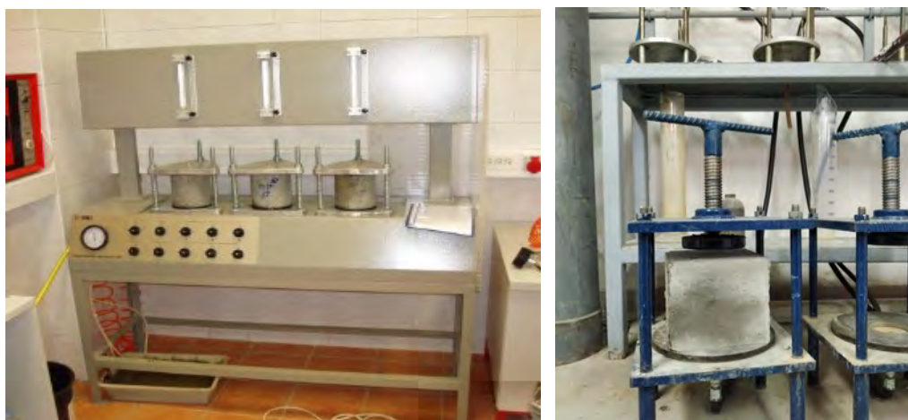
Fig. 3.7. Pajisje për hulumtim të papërshkueshmërisë së betonit
