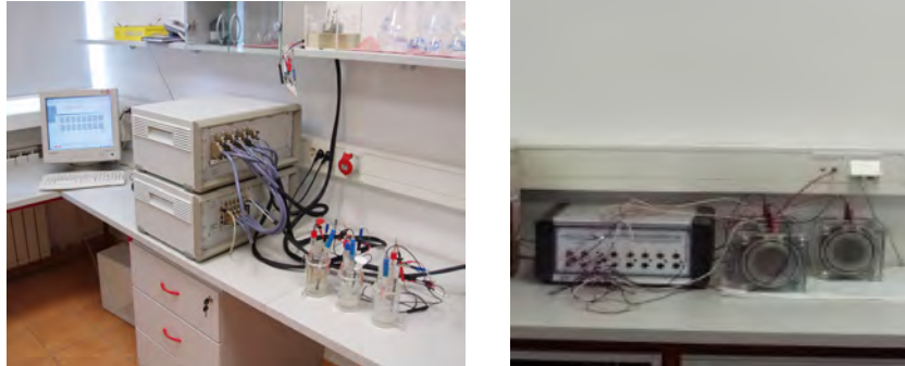
Fig. 3.10. Pajisja për hulumtim të shpejtë të rezistencës ndaj korrozionit të betonit
