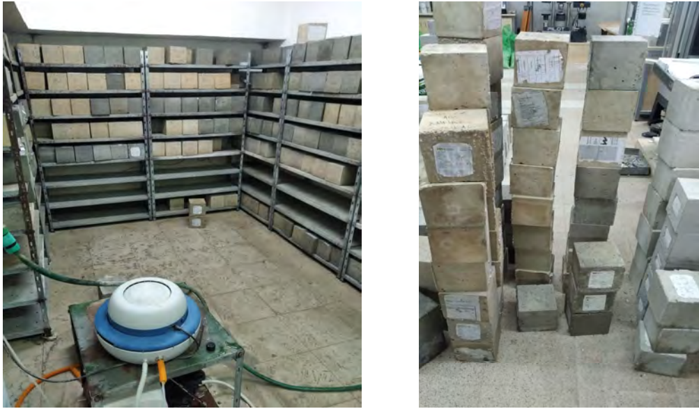
Fig. 3.1. Kube provuese për hulumtim të betonit 15/15/15 cm
