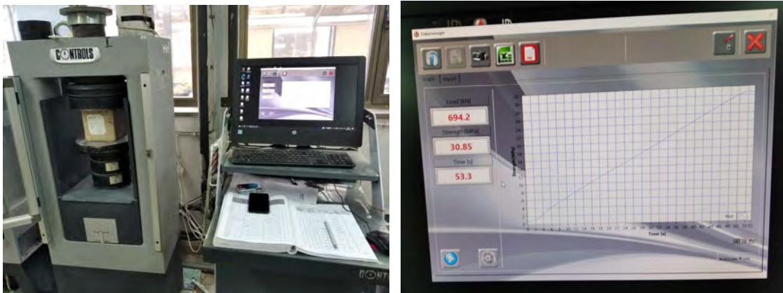
Fig. 3.3. a) Pajisje për hulumtimin e qëndrueshmërisë në shtypje
